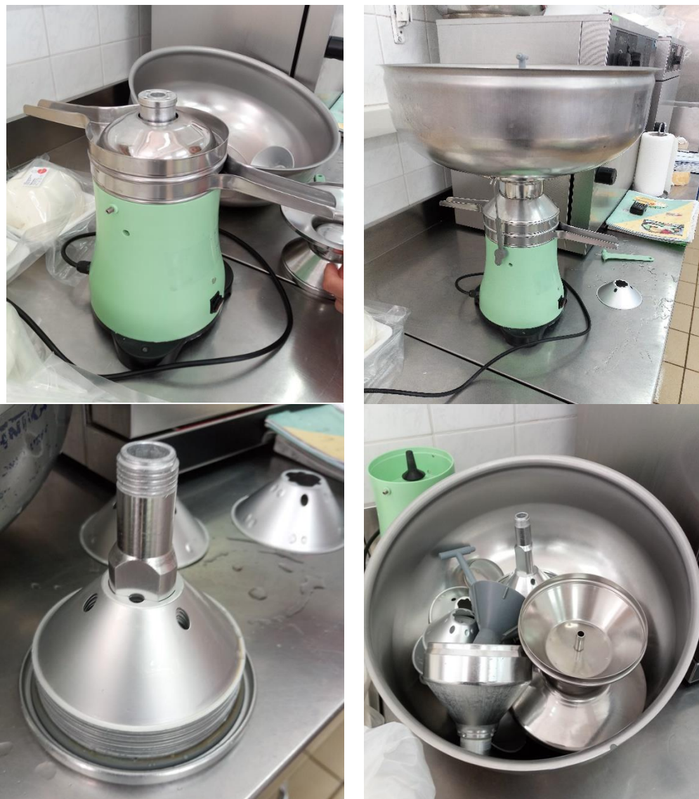
Слика 1. Сепаратор и составни делови на сепараторот
